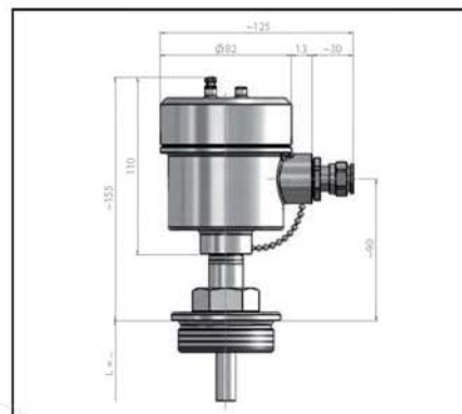
Тип соединения: AVA / AVDA (Exd) Материал: Нержавеющая сталь A4 (SS316) Кабельный ввод: M20 x 1,5 Класс защиты от проникновения загрязнений: IP 67 / (Exd / IP68) Температура окружающей среды: -40°C ... 85°C
